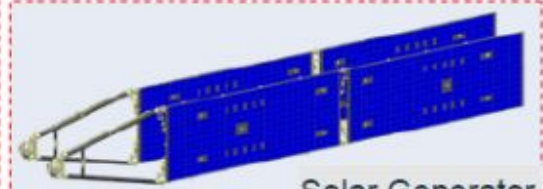
Solar Generator Module
